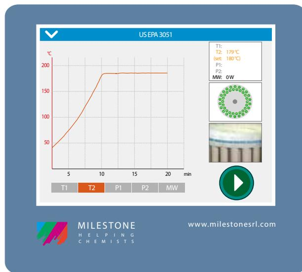
El perfil de temperatura de una digestión de suelo conforme a la norma US EPA 3051 utilizando el rotor MAXI-44
