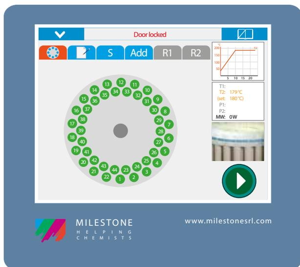
Este diagrama del rotor representa la temperatura de digestión en todos los vasos. El color verde indica si el vasos ha logrado las condiciones establecidas
