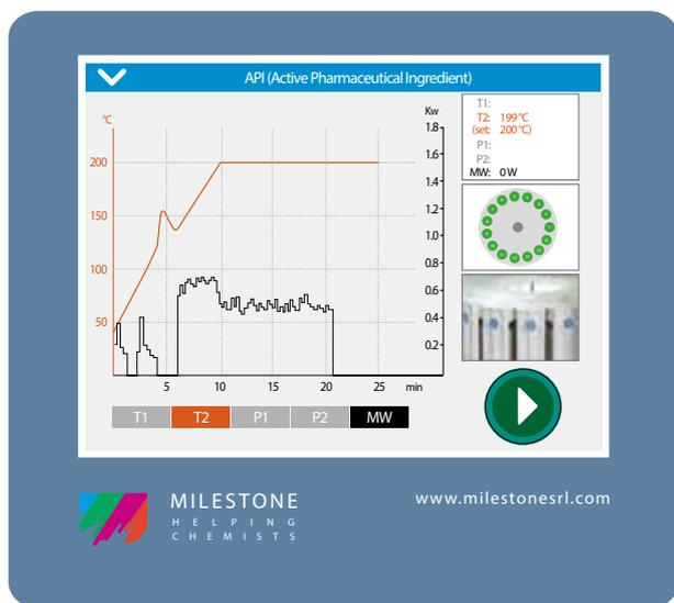
El sistema EasyTEMP de control de la temperatura de una reacción exotérmica durante la digestión de un API con  $HNO_3$  y  $HCl$  en el rotor SK-15
